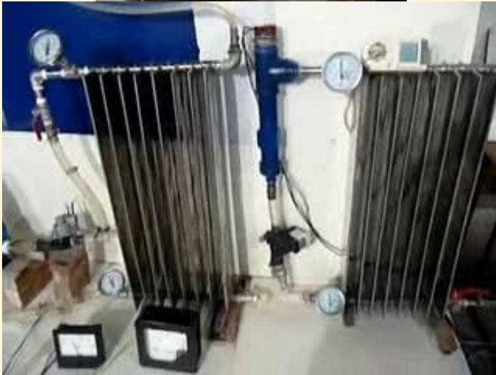
Рис. 165. Фото батарей, нагреваемых плазмотеплолизёром (слева) и ТЭНом (справа).
