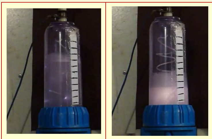
Рис. 173. Плазменный электролизёр с самонастраивающимся резонансным режимом работы
