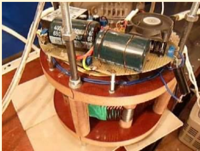
Рис. 160. Фото электромотора-генератора МГ-1
